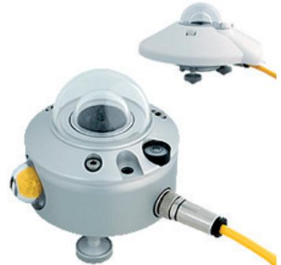
Je nach Wetterlage kann sich Tau, Eisregen oder auch Raureif am äußeren Dom niederschlagen und dort in den Morgenstunden auch längere Zeit verbleiben. Eine Eisschicht auf dem Dom verursacht eine enorme Streuung der Strahlung und erhöht das Pyranometersignal drastisch bis zu 50% in den ersten Stunden nach Sonnenaufgang. Auch Schnee kann den Dom komplett bedecken.
